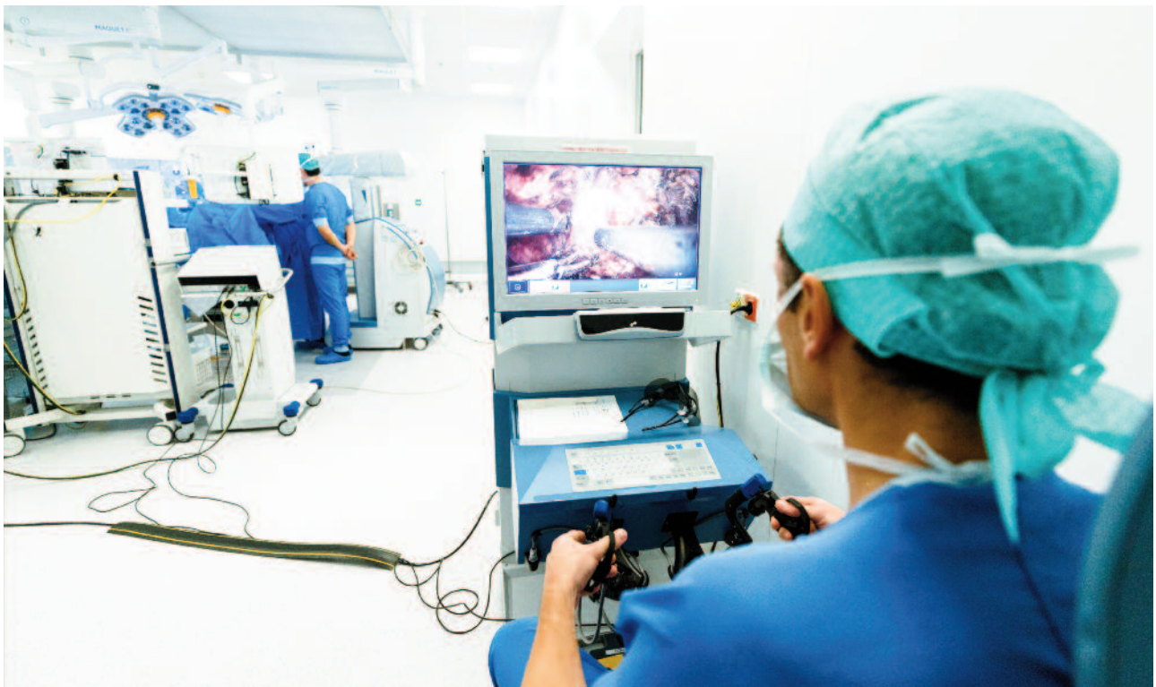
Figuur 2. Senhance-operatierobot van TransEnterix die in MMC sinds november 2018 gebruikt wordt bij laparoscopische procedures in de urologie, gynaecologie en algemene chirurgie.
