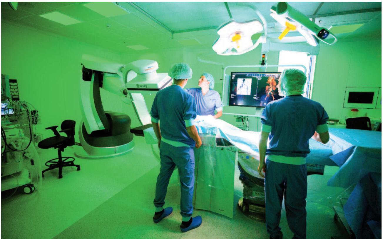
Figuur 1. Siemens Pheno robot-arm in de nieuwe hybride OK van MMC, met doorlichtingssysteem ten behoeve van geavanceerde intra-operatieve beeldvorming.
