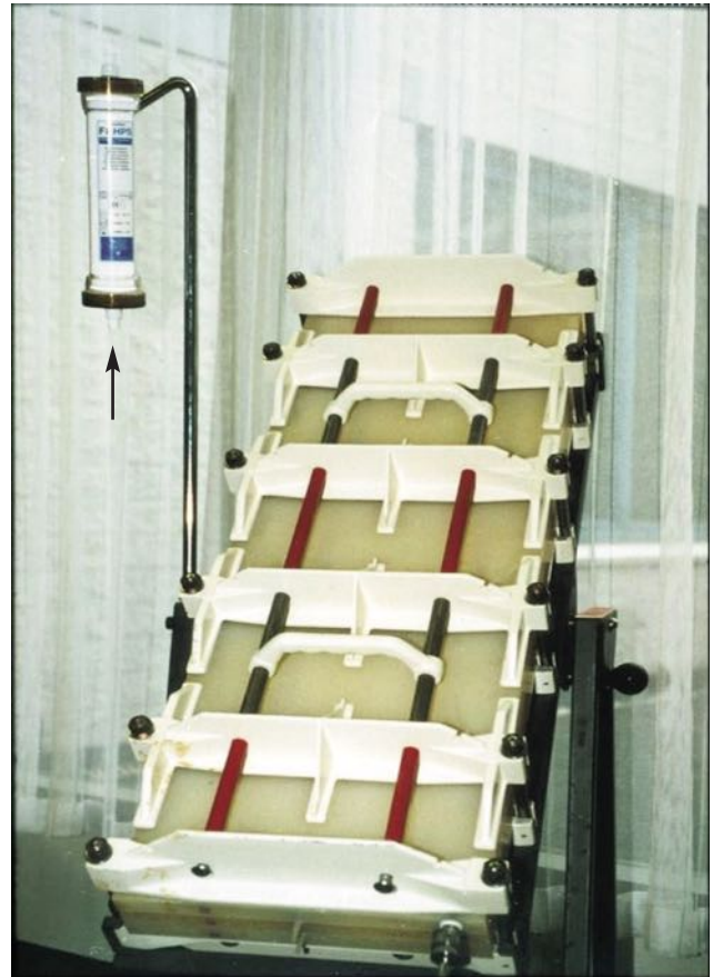
Kunstnier 1970 en 2020, de grote platennier is prominent in beeld (1970), en de kleine cilinder die eraan hangt is onze moderne kunstnier (2020, zie pijl).
